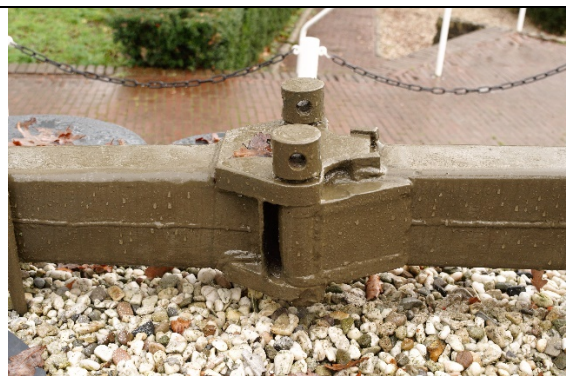
Figuur 7 Foto van de bevestiging van het onderste been van het spreidaffuit. Door een van de pennen te verwijderen kon je het been verdraaien.
