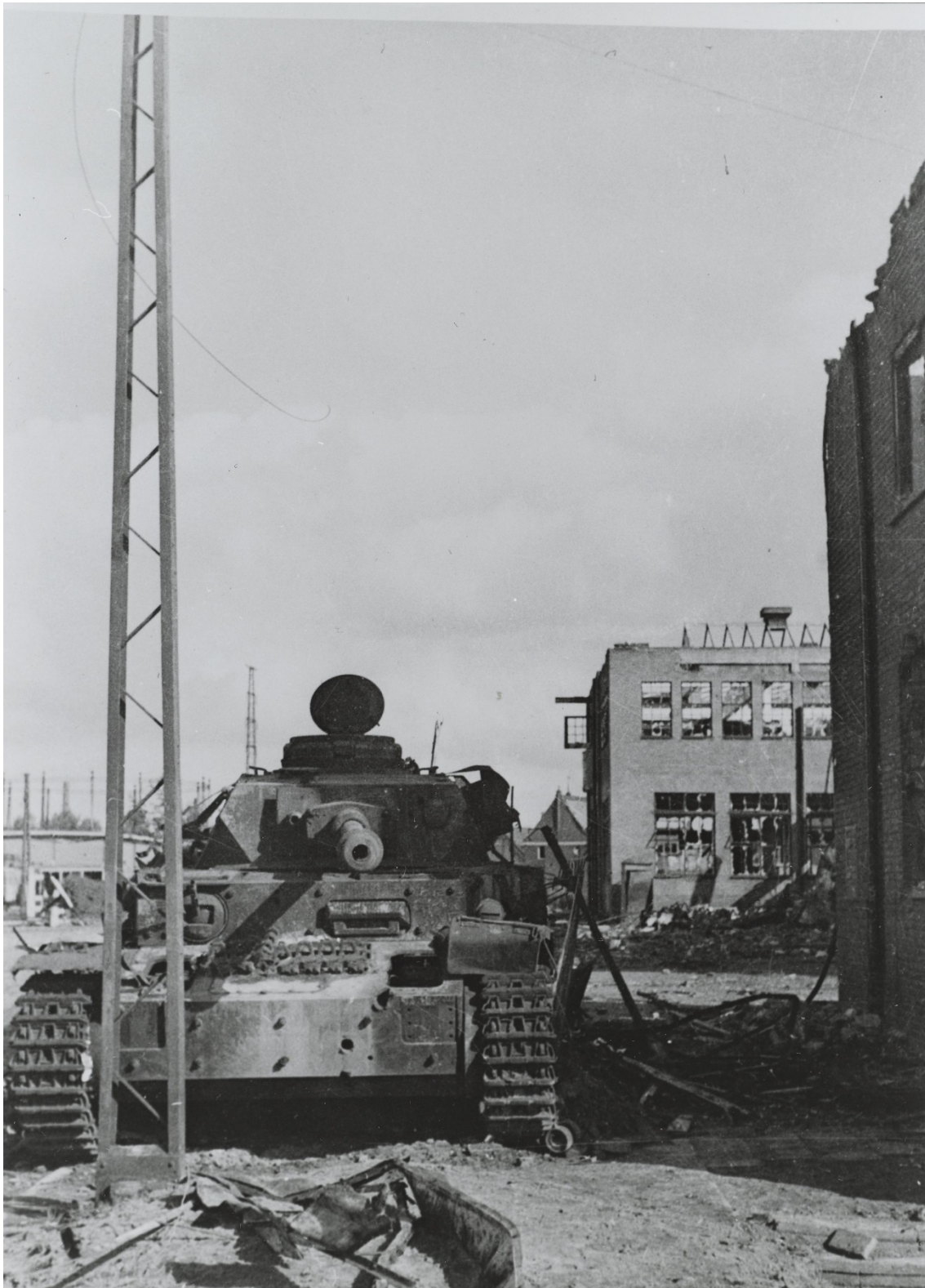
Figuur 6 De rupsband is zeer waarschijnlijk afkomstig van deze Panzer IV Ausf H. Voor op de boeg zijn twee gaten herkenbaar die op de plaats van de bestuurder de tank hebben getroffen. Qua doorsnede zouden ze afkomstig kunnen zijn van het stuk van Robson en /of Kill (Bron: 2155-000540, NIMH).
