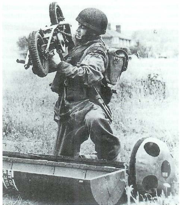
Een parachutist tilt een Welbike uit een container tijdens een oefening. (foto: Imperial War Museum, Londen)
